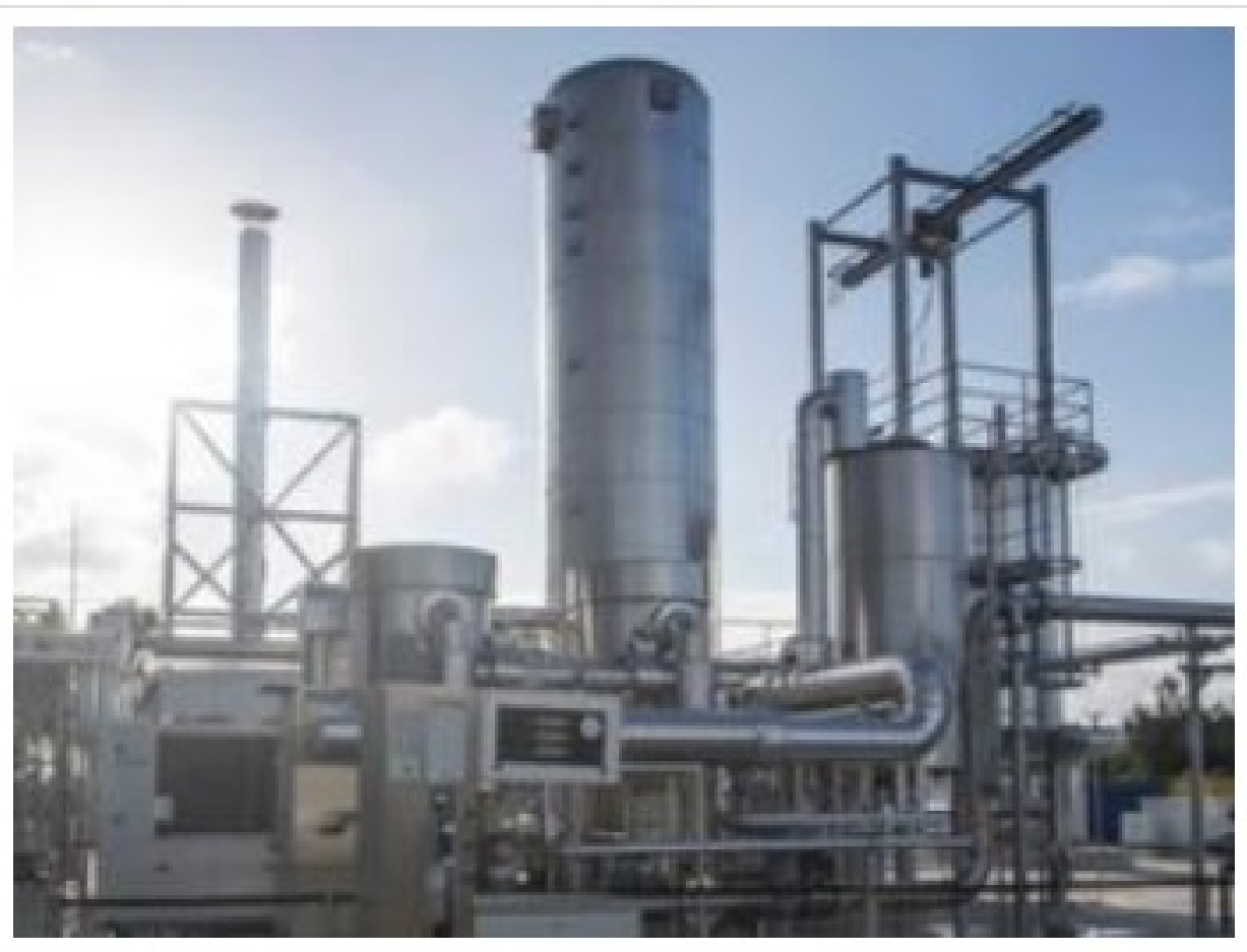
Power-to-Gas-Anlage mit 6 MW elektrischer Eingangsleistung für die Synthetisierung von erneuerbarem Erdgas bei Audi (Foto: Audi AG)
